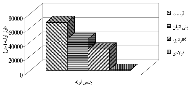
شکل ۳- وضعیت جنس لوله های شبکه منطقه پایلوت
