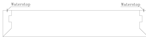
Fig. 10. First part of the wall with wedge-shaped section شکل ۱۰- اولین پارت دیوار با مقطع گوه‌ای شکل
