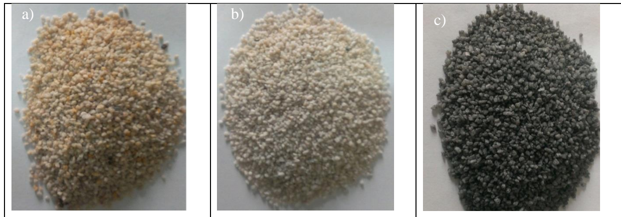
Fig. 3. a) Raw silica, b) silica washed with acid and c) silica coated with nanotubes (شکل ۳- a) سیلیس خام، b) سیلیس شسته شده با اسید و c) سیلیس پوشش یافته با نانولوله
