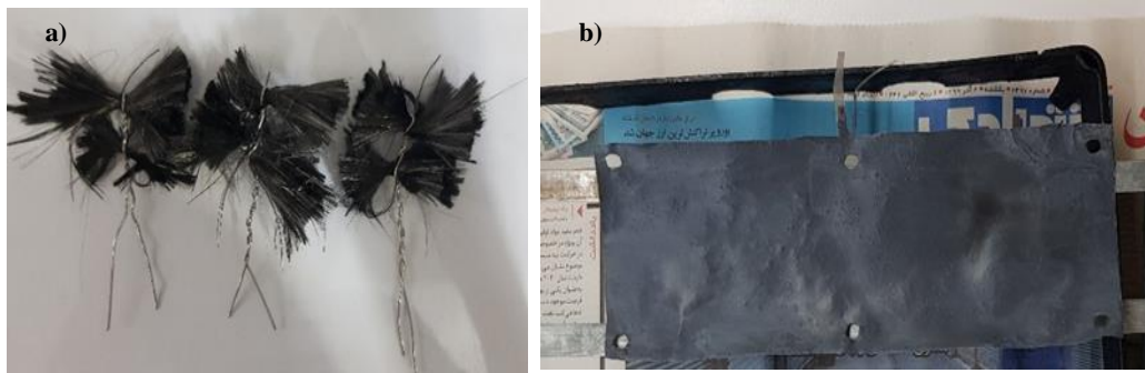
Fig. 3. a) Photo of the constructed brush anodes, b) photo of the constructed air-cathode شکل ۳- a) تصویر آندهای بررسی و b) تصویر هوا-کاتد
