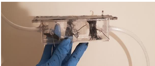
Fig. 2. Photo of the constructed microbial fuel cell (شکل ۲- تصویر پیل سوختی میکروبی ساخته شده)
