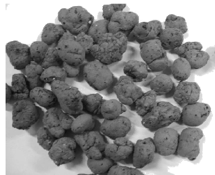
شکل ۳- سنگ دانه های مصنوعی لیکا مورد استفاده به عنوان آکنه
