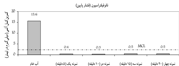
شکل ۴- فرایند نانوفیلتراسیون در فشار عملیاتی ۴ بار برای حذف کربن کل آلی آب مصنوعی
