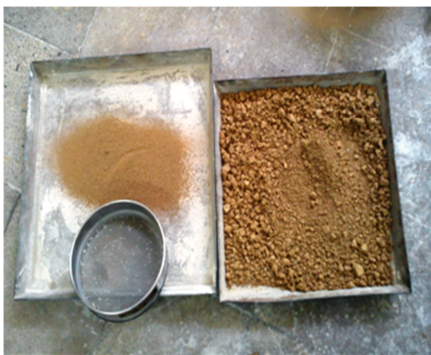
شکل ۱- لجن خشک شده قبل و بعد از عبور از الک نمره ۱۶
