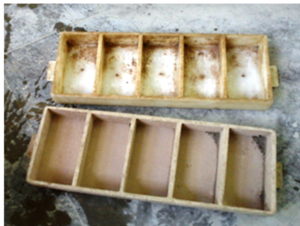
شکل ۲- قالب‌های مخصوص آجر از جنس فایبرگلاس
