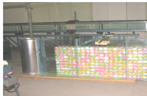
شکل ۵- محیط متخلخل توپی با قطر ۷/۵ سانتی متر
