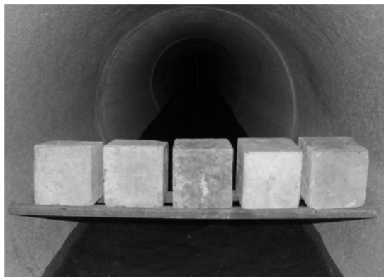
شکل ۳- قرار دادن نمونه‌های بتنی در فضای بالای خط جریان در مجاری انتقال فاضلاب
