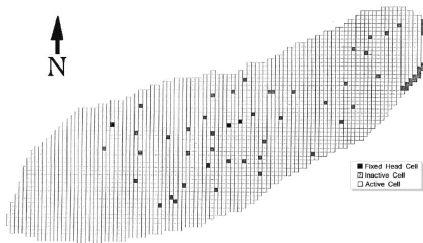
شکل ۲- شبکه مربعی طراحی شده و سلول های فعال، غیرفعال و دارای بار ثابت
