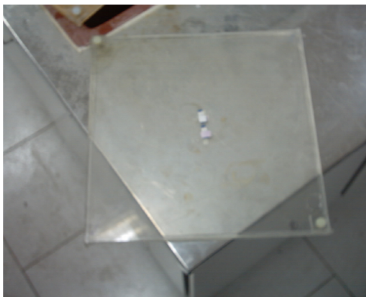
شکل ۲- دُز دریافتی نمونه توسط فیلم های مخصوص دُزیمتری که بر روی ظروف حاوی نمونه نصب شده است، با روش اسپکتروفوتومتری اندازه‌گیری می‌شود.
