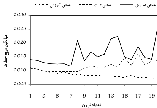
شکل ۶- تغییرات خطای داده‌های آموزش، تست و تصدیق با افزایش تعداد نرون‌های لایه مخفی
