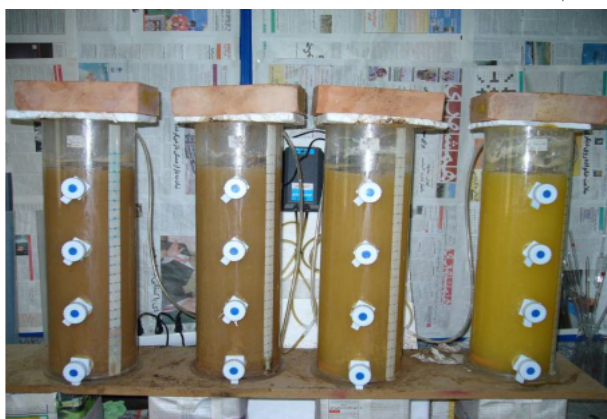
شکل ۱- نمایی از راکتورهای SBR استفاده شده در این تحقیق
