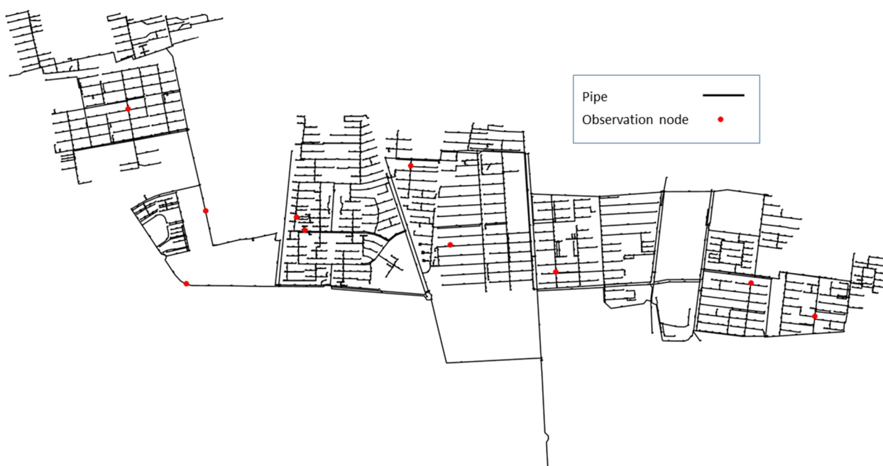
Fig. 2. Location of pressure sensors used in roughness calibration شکل ۲- موقعیت فشارسنج‌های مشاهداتی به کار گرفته شده برای کالیبراسیون زبری
