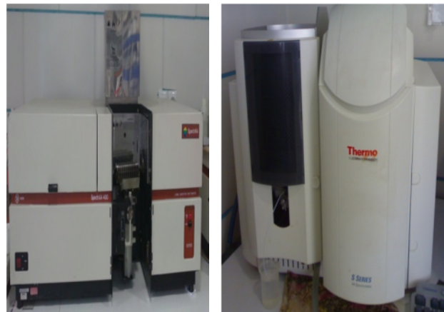
شکل ۴- سمت راست، دستگاه جذب اتمی مدل ترمو، سمت چپ، دستگاه جذب اتمی مدل واریان
