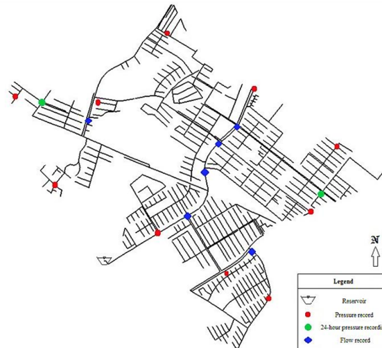
Fig. 3. Location of observed pressure and flow rate in I1 water distribution network شکل ۳- موقعیت نقاط اندازه‌گیری فشار و جریان در سطح شبکه I1
