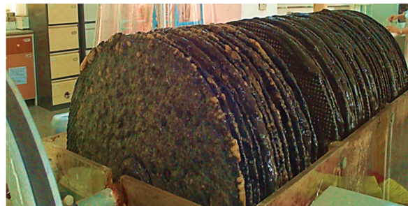
Fig. 2. The formation of attached biofilm (on discs) at the end of discontinuous operation cycle of the reactor شکل ۲- تشکیل بیوفیلم چسبیده بر روی دیسک‌ها در انتهای دوره کارکرد ناپیوسته راکتور
