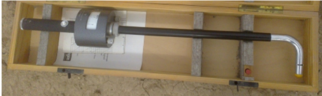
شکل ۶- لوله پیتوت مخصوص اندازه‌گیری سرعت جریان هوا
