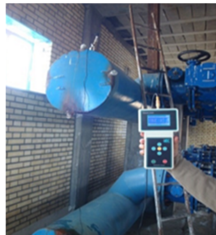
Fig. 6. Data logger & pressure sensor in Bukan شکل ۶- ثبت کننده داده‌ها و سنسور فشار بوکان
