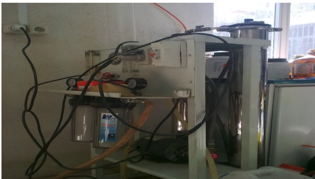
شکل ۳- پایلوت نانو فیلتراسیون مورد استفاده در این تحقیق
